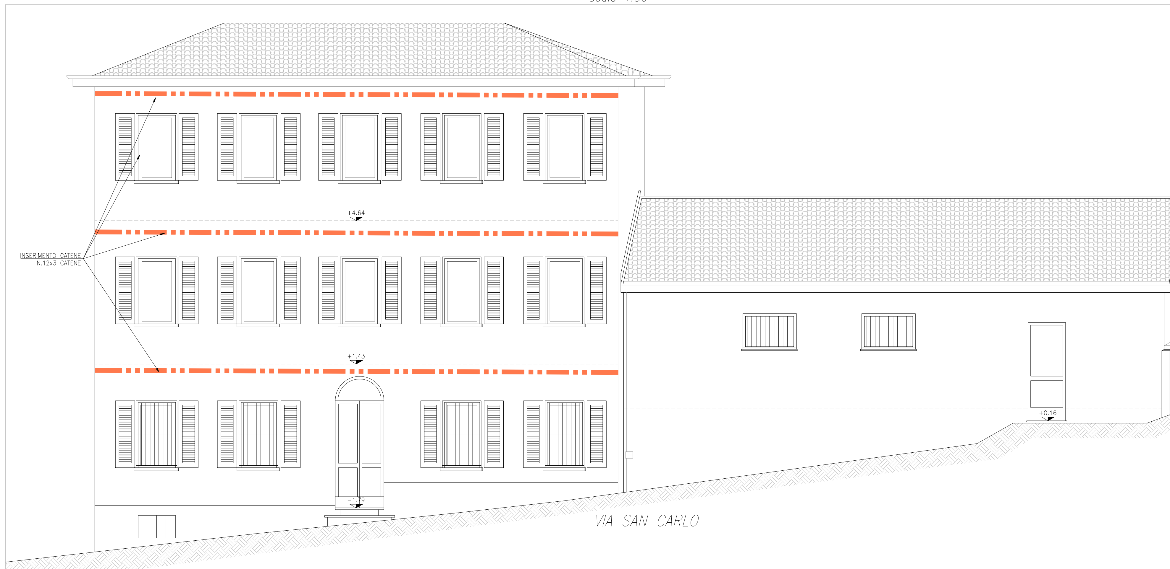
INSERIMENTO CATENE - PIANTE PIANO RIALZATO scala 1:50
