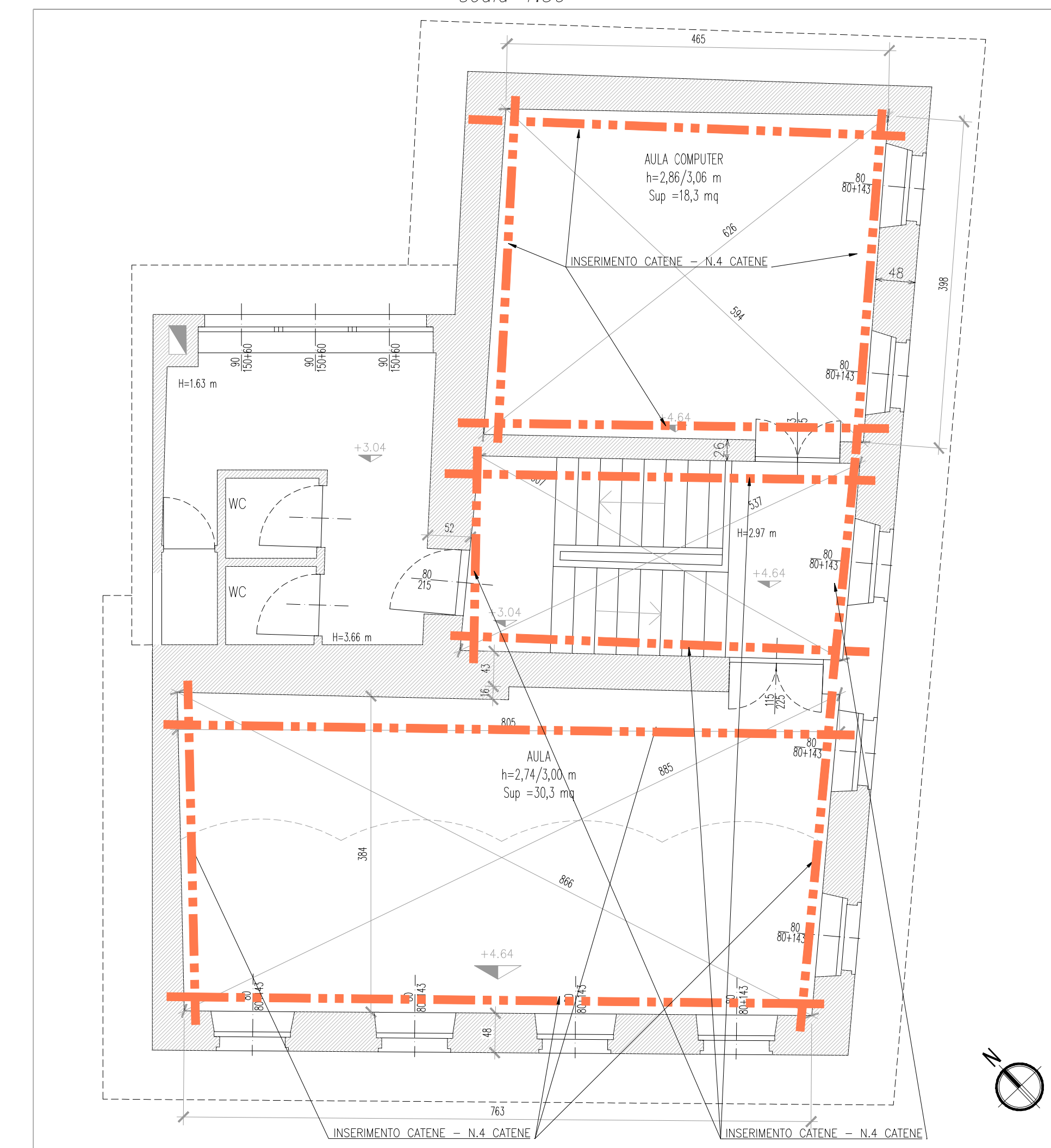
INSERIMENTO CATENE - PIANTE PIANO PRIMO scala 1:50
