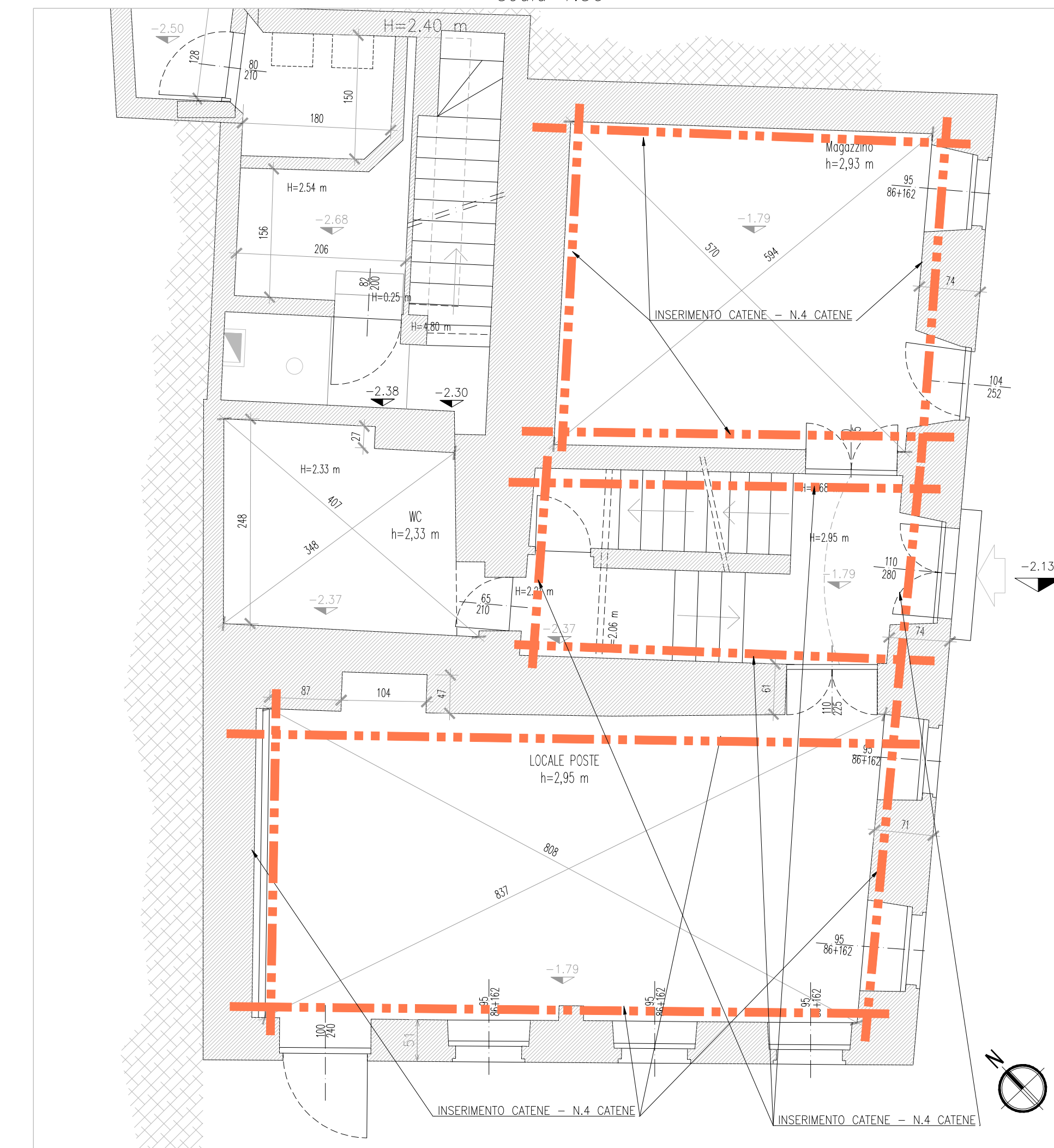
INSERIMENTO CATENE - PIANTE PIANO SEMINTERRATO scala 1:50
